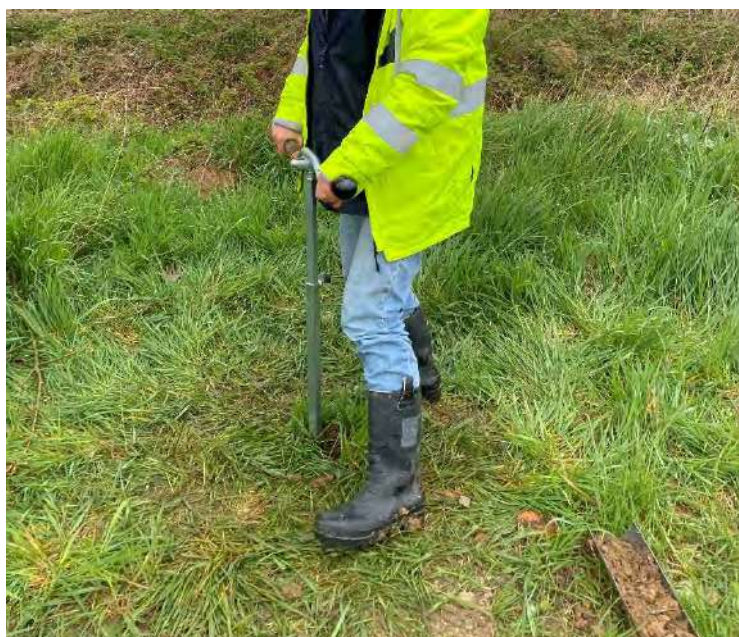
Figure 5 – Sondage à la tarière à main, © ARP-Astrance 2022
