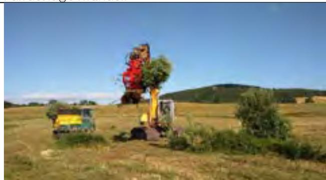
Exemple d'arrachage mécanique (en site naturel) à la pince sur pelleuse
