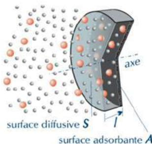
*Les surfaces diffusible et adsorbante de l'échantillonneur diffusif axial sont deux faces planes et opposées d'une boîte fermée, d'habitude cylindrique. Sous un gradient de concentration, les molécules adsorbables (en couleur sur le schéma) pénètrent la surface diffusible et viennent d'être piégées par celle adsorbante.*
